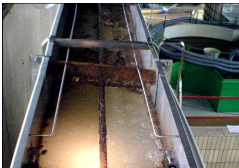
Obrázek 22. Hladina na poloprovozním modelu DAF při provozu s nadávkovanou vodou optimální dávkou síranu hlinitého po ukončeném shrabování kalu (2. etapa experimentů) [P. Dobiáš]
