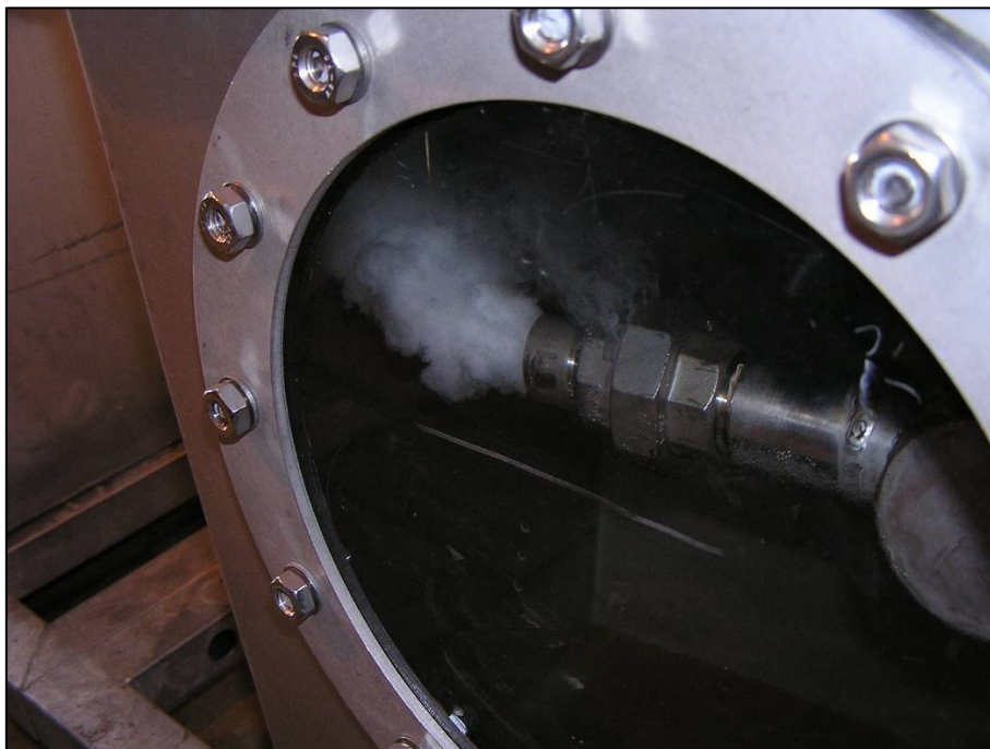
Obrázek 2. Bílá voda proudící z expanzních trysek [P. Dobiáš]
