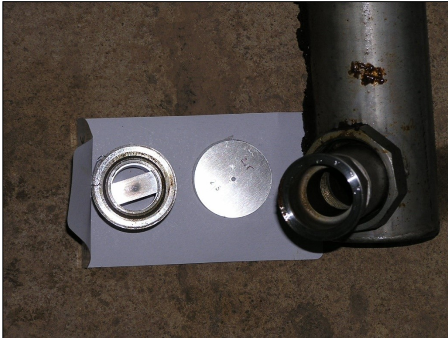
Obrázek 1. Příklad flotační disperzní trysky (Xylem Leopold)[P. Dobiáš]
