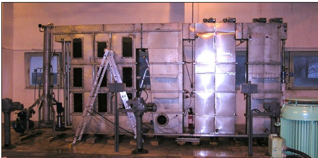
Obrázek 9. Poloprovozní model DAF na ÚV Plzeň [P. Dobiáš]
