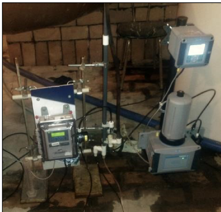
Obrázek 11. Použitý kontinuální počítací částic (vlevo) (Hach) a kontinuální laserový zákaloměr (vpravo) (Hach) [P. Dobiáš]
