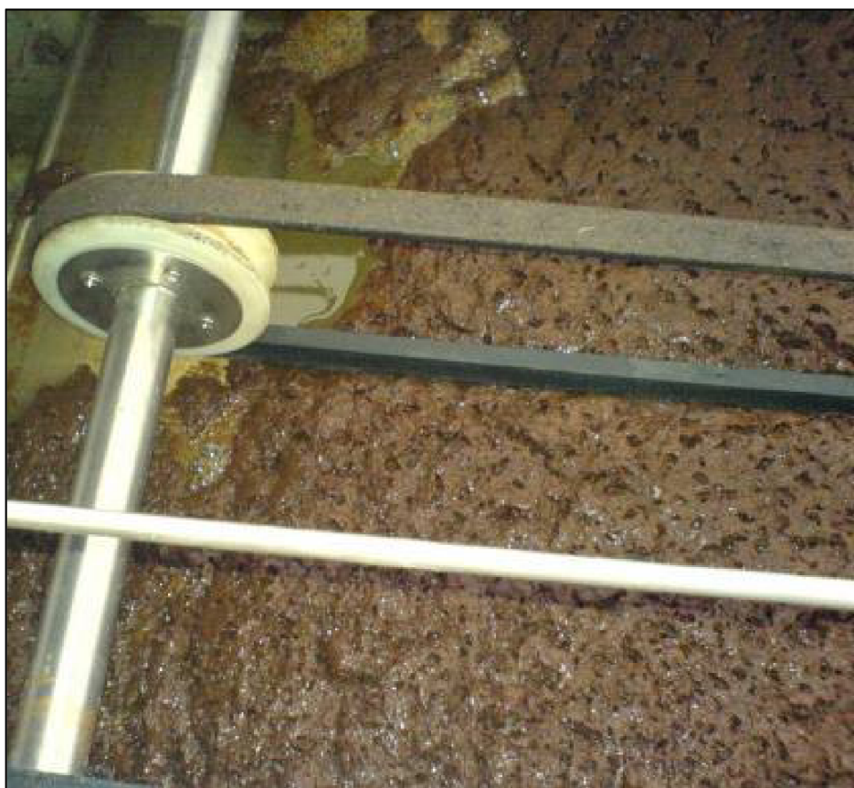
Obrázek 15. Kal na hladině konce separační zóny modelu flotace při režimu provozu s hydraulickým odkalováním a bez přidavku umělého zákalu [P. Dobiáš]
