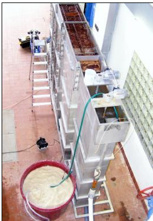
Obrázek 12. ÚV Znojmo – simulace zákalu pomocí dávkování bentonitové suspenze [P. Dobiáš]
