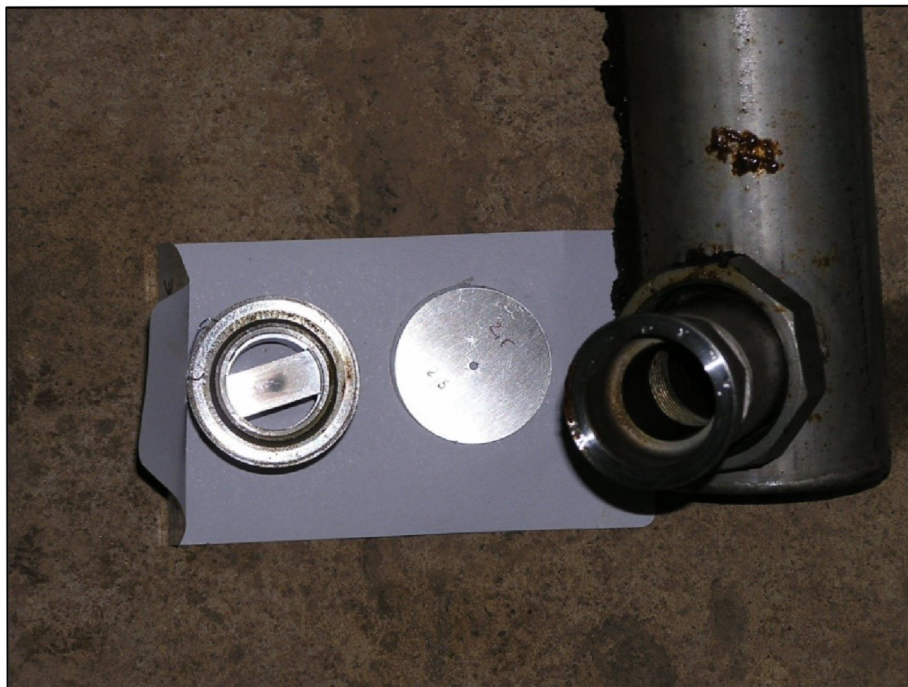
Obrázek 1. Příklad flotační disperzní trysky (Xylem Leopold)[P. Dobiáš]
