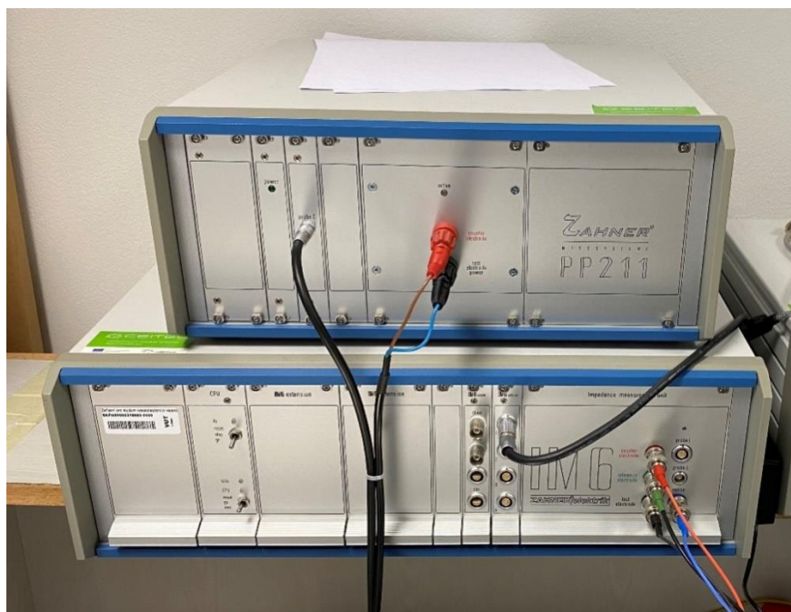
Obr. 7.1 Měřicí sestava CIMPS od firmy Zahner
