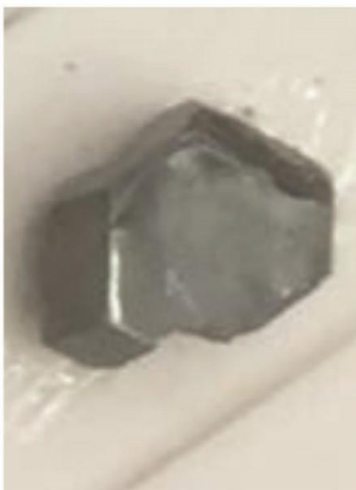
Obr. 5.2 Fotografie monokrystalu \text{MAPbI}_3 po skladování na vzduchu po dobu 2 let bez jakéhokoliv zapouzdření [31]
