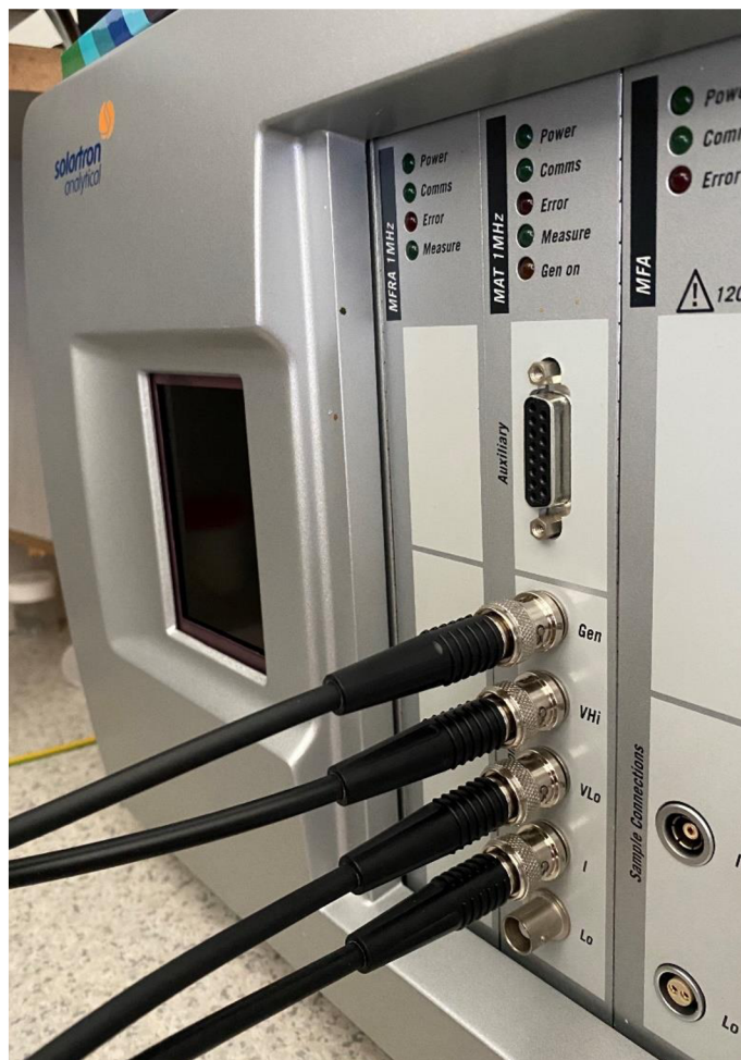
Obr. 7.4 Zapojení materiálového modulu MAT pro měření cyklické voltametrie
