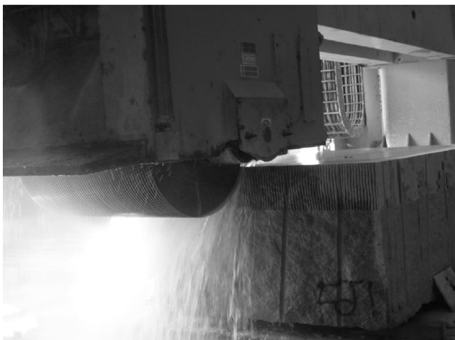
Obr. 14 - Broušení a řezání žulových bloků [12]
