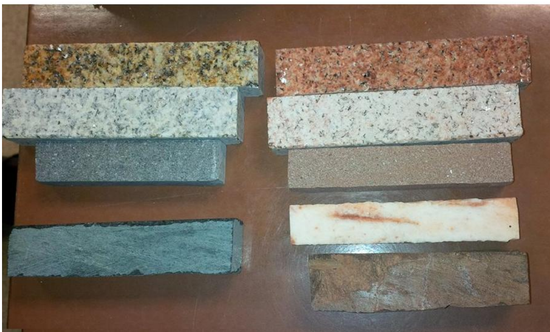
Obr. 17 - vzorky použité na DKTA analýzu v praktické části
