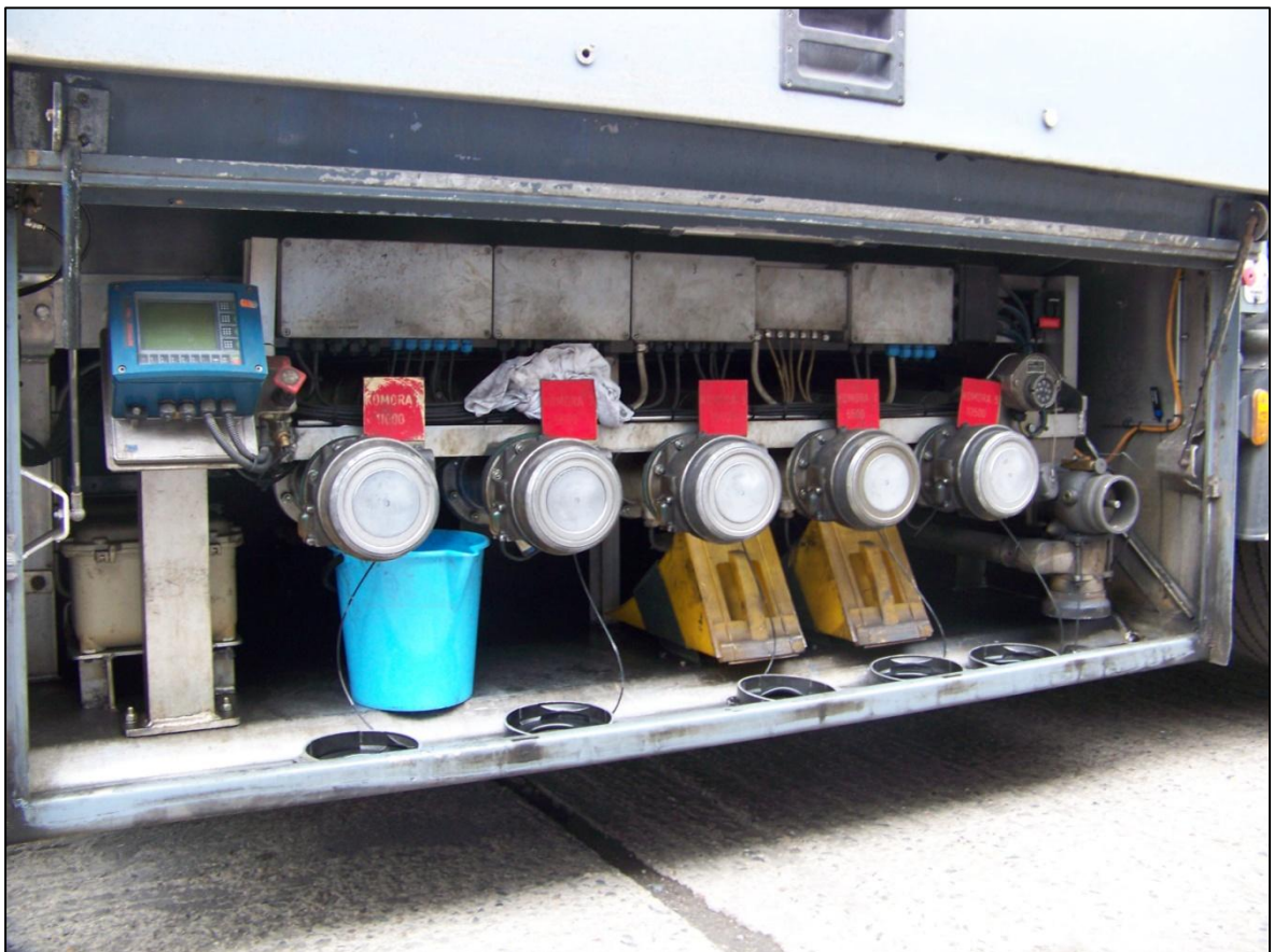
Obr 16. Spodní plnění cisternového návěsu L.A.G. , s 5 komory a tyčovým měřicím zařízením Bartec [19]
