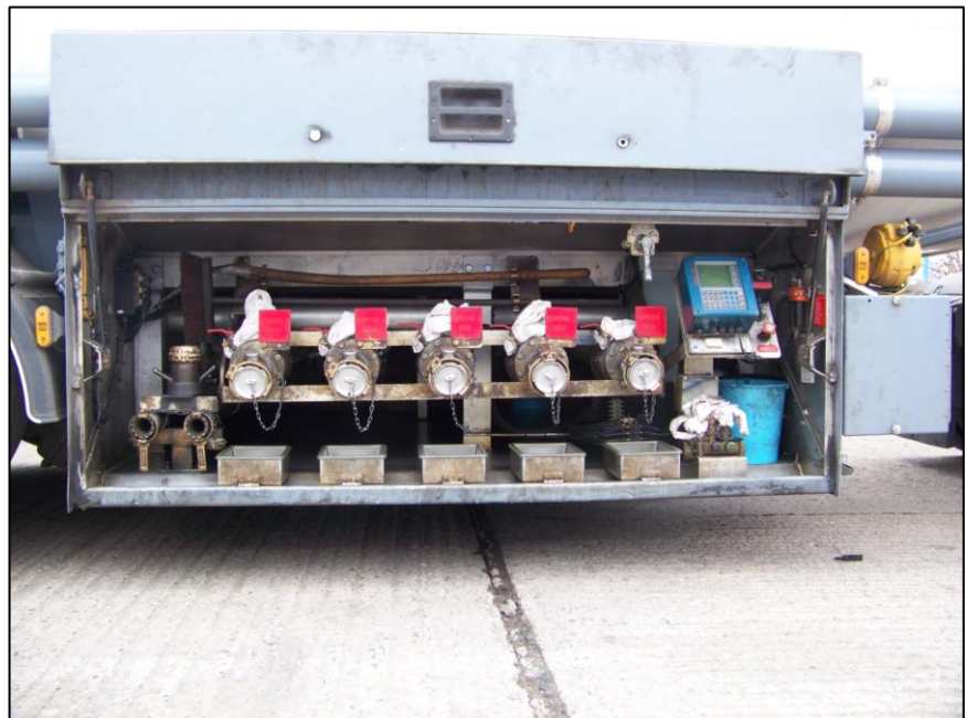
Obr 13. Stáčecí systém cisterny L.A.G., s 5 komory a tyčovými měřicími přístroji Bartec [19]
