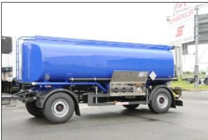
Obr 7. Cisternová nástavba skříňového tvaru na podvozku přívěsu [14]
