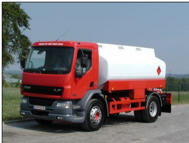
Obr 10. Cisternová nástavba skříňového tvaru na podvozku DAF [8]
