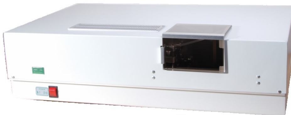
Obr. č. 6: Atomový absorpční spektrometr – AMA 254 [56]
