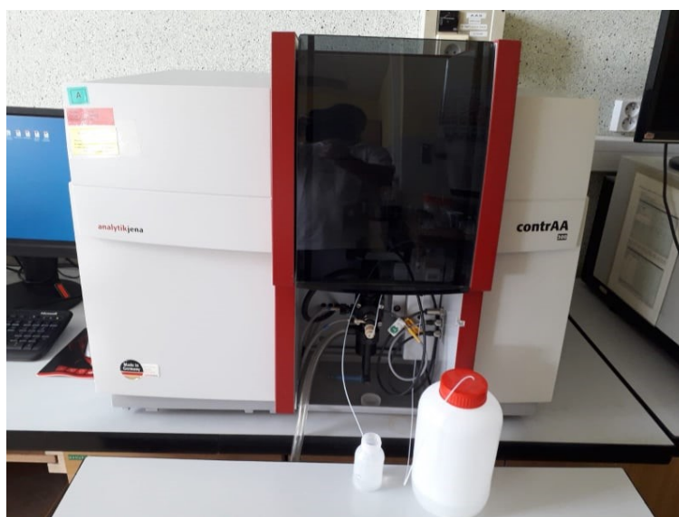
Obr. č. 7: Atomový absorpční spektrometr s atomizací v plameni – ContrAA 300
