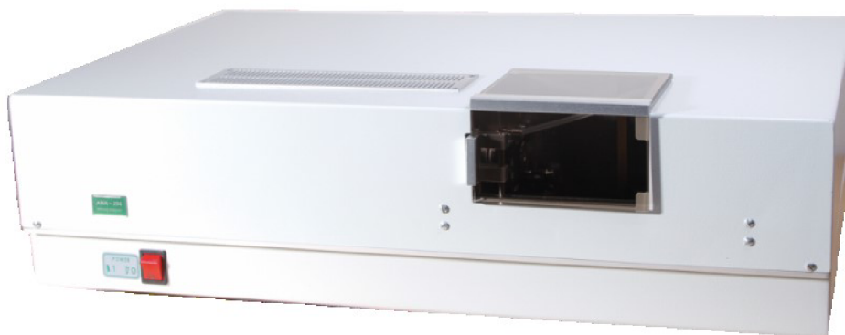
Obr. č. 6: Atomový absorpční spektrometr – AMA 254 [56]
