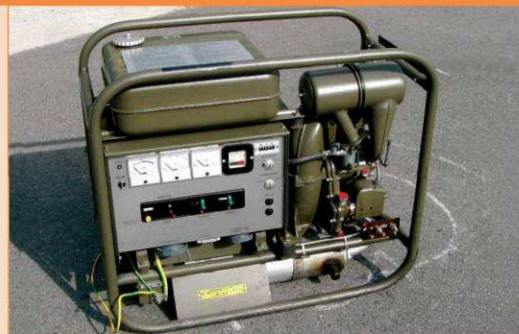
Elektrocentrála EC 3 kW
