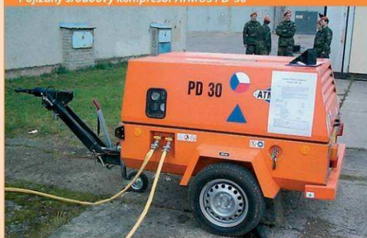
Pojízdný šroubový kompresor ATMOS PD-30
