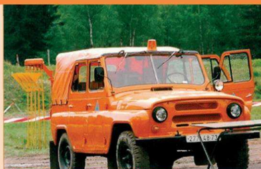
Chemický průzkumný automobil UAZ-469CH
