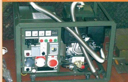
Elektrocentrála EC 2 kW
