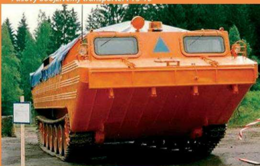
Pásový obojživelný transportér PTS-10
