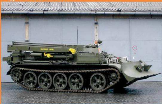
Vyprošťovací tank VT-55 A
