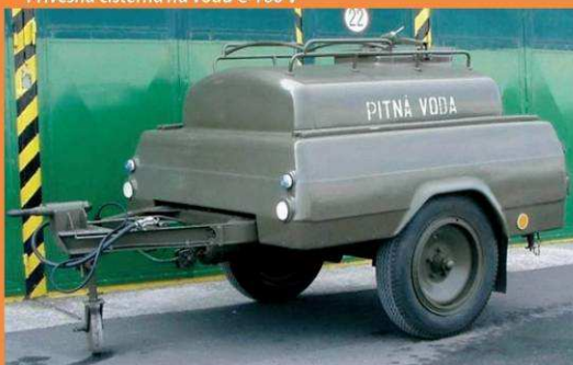
Prívěsná cisterna na vodu C-180 V
