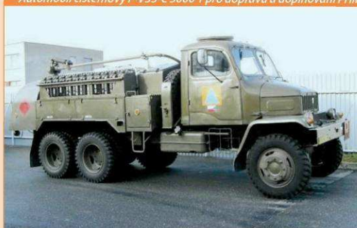
Automobil cisternový P-V3S-C 3000 1 pro dopravu a doplňování PHM
