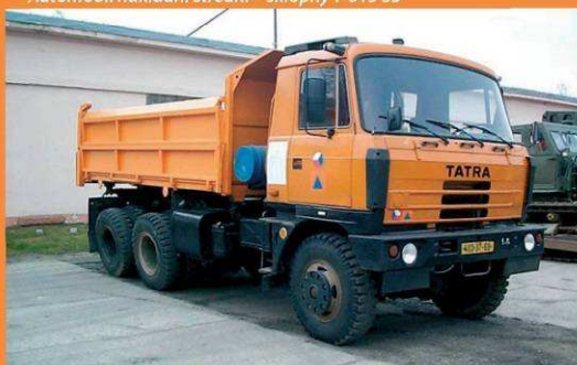
Automobil nákladní střední – sklopný T-815 S3
