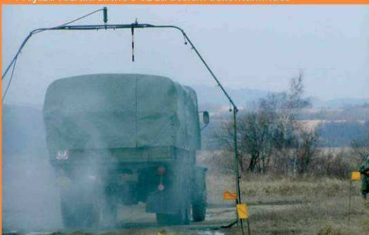
Průjezd vozidla LINKOU 82 za účelem dekontaminace
