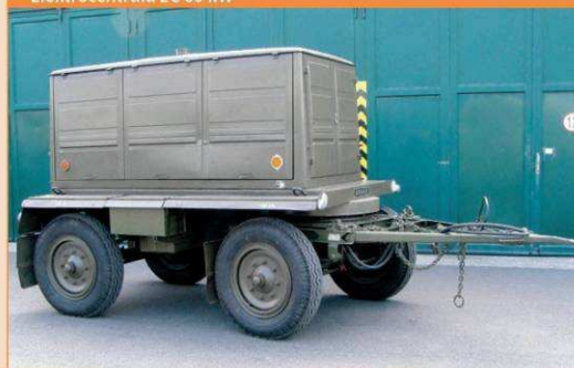
Elektrocentrála EC 60 kW
