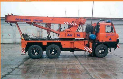
Automobil vyprošťovací AV-14
