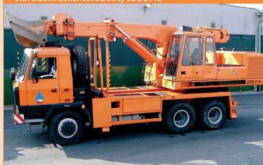
Univerzální dokončovací stroj UDS 214a
