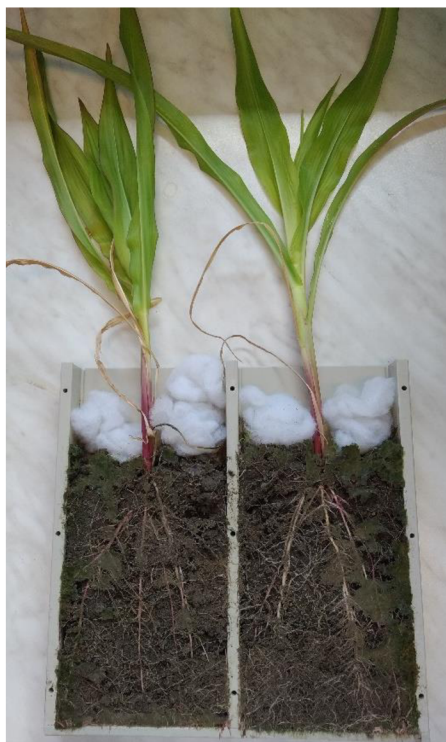
Obr. 3: Příklad rhizoboxu s kukuřicemi na konci pokusu, po odstranění krycího plexiskla.
