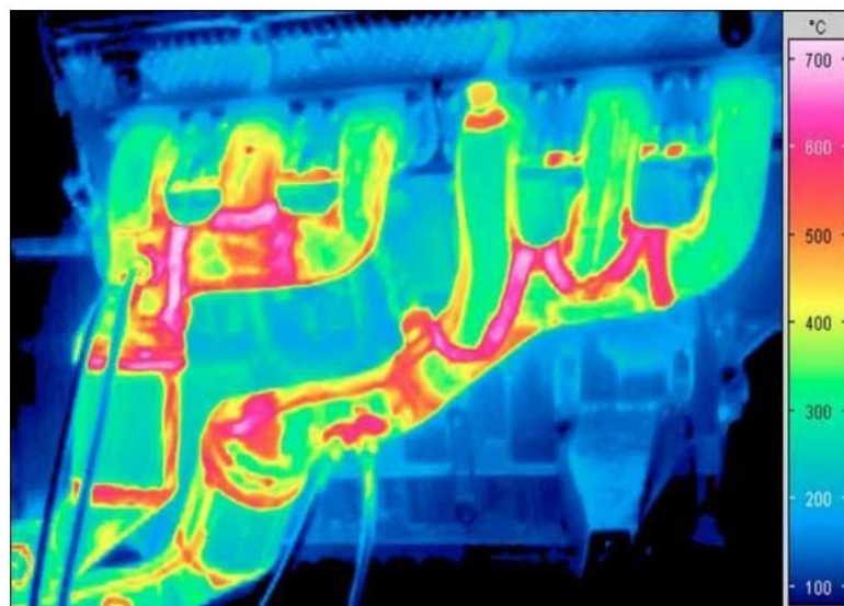
Obr.50: Teplotní pole ve sběrném potrubí výfukových plynů. [28]
