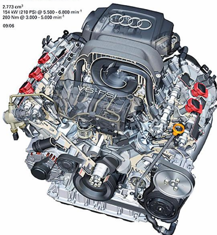
Obr.6: Šestiválcový motor koncernu Audi – Volkswagen o objemu 2,8 l využívající proměnnou délku sacího potrubí ovládanou přepínacím válcem s podtlakovým ovladačem. Tento motor byl pod označením AMX montován do vozů VW Passat B5 nebo Škoda Superb 1. generace. [6]
