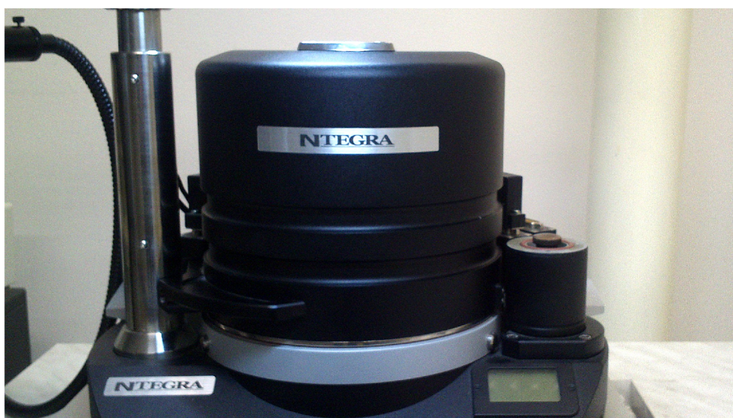
Obrázek 3.4: Mikroskop NTegra od firmy NT-MDT s měřící komorou.
