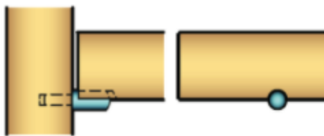
Obr. 28 Zapuštění podpěry do spodní plochy police (Holouš a Máchová, 2013)
