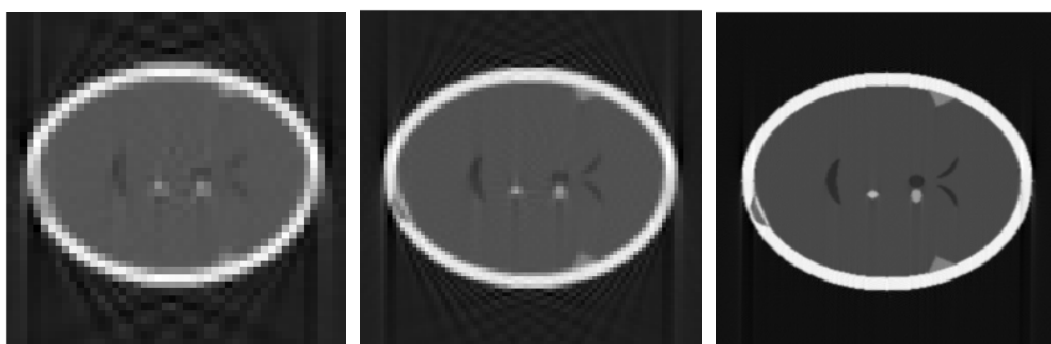
Obr. 4.13: Simulace aliasing artefaktu - detektory, počet detektorů: a) 70, b) 120, c) 360
