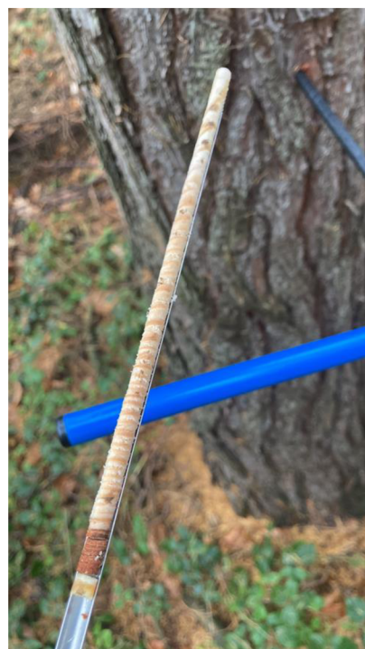
Obr. 3, Odběrová jehla se vzorkem (Židek, 2022)
