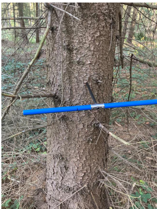
Obr. 4, Odebírání vzorku pomocí Presslerova nebozezu (Židek, 2022)
