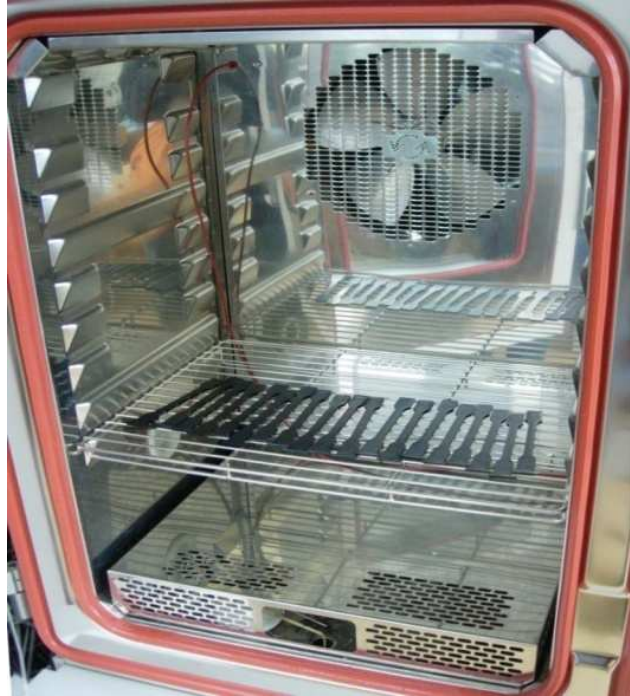
Obr. 3.4 Klimatizační skříň Vötsch VC 0018 se zkušebními vzorky
