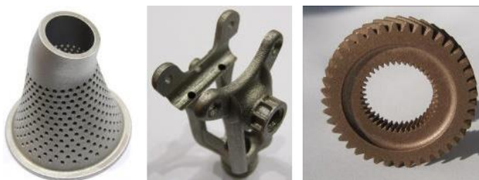
Obr. 10 Příklady prototypů zhotovených pomocí DMLS. Zleva: nerezová ocel, titan, bronz [6]
