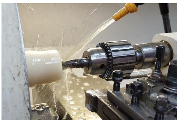
Obr. 31 Vrtání otvoru Ø14mm
