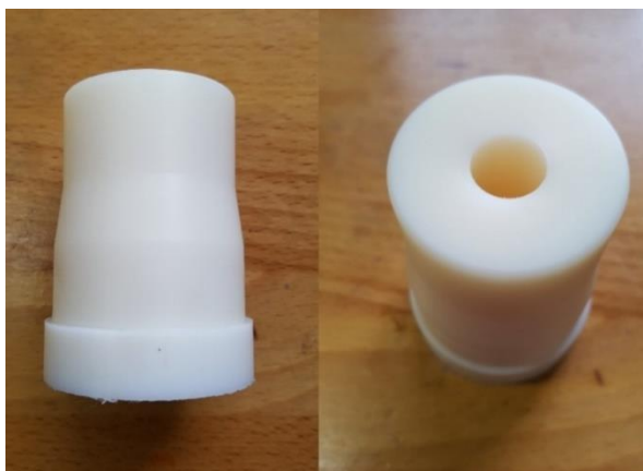
Obr. 32 Díl po provedení soustružení vnější kontury a vrtání
