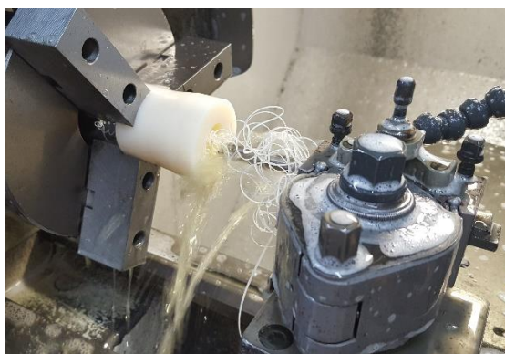
Obr. 35 Soustružení vnitřní kontury
