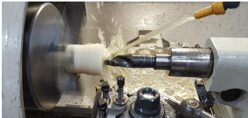
Obr. 33 Vrtání technologického otvoru
