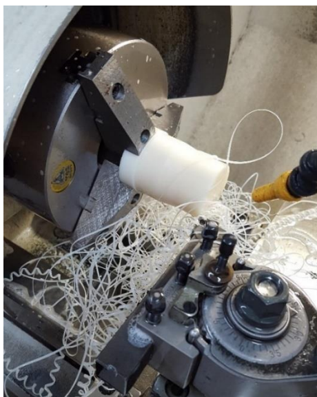
Obr. 30 Proces obrábění vnější kontury
