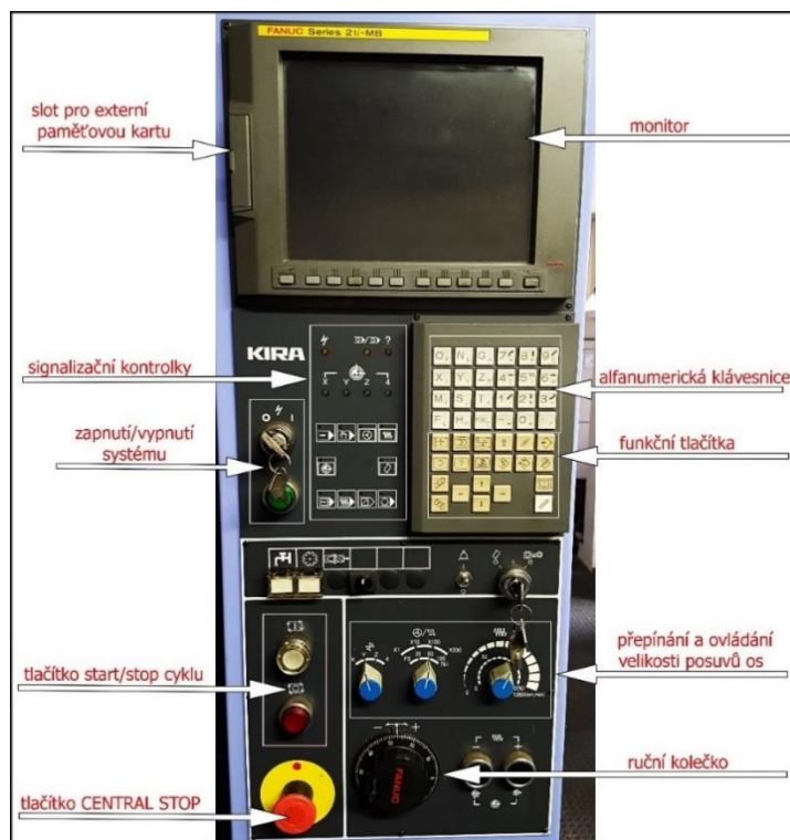
Obr. 15 Popis řídícího panelu Fanuc 21i-MB na frézovacím centru
