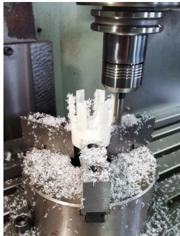
Obr. 38 Průběh frézování výstupků
