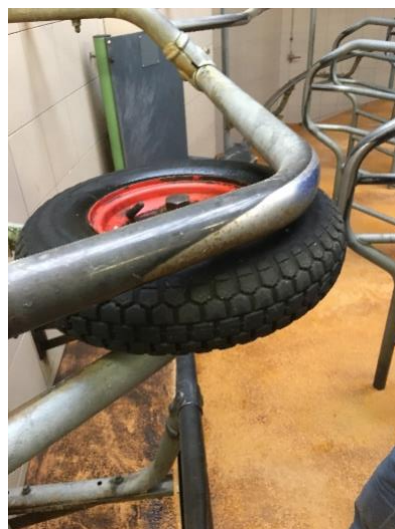
obr. 3 Kolo, pomáhající ke správnému otáčení krav do dojícího boxu
