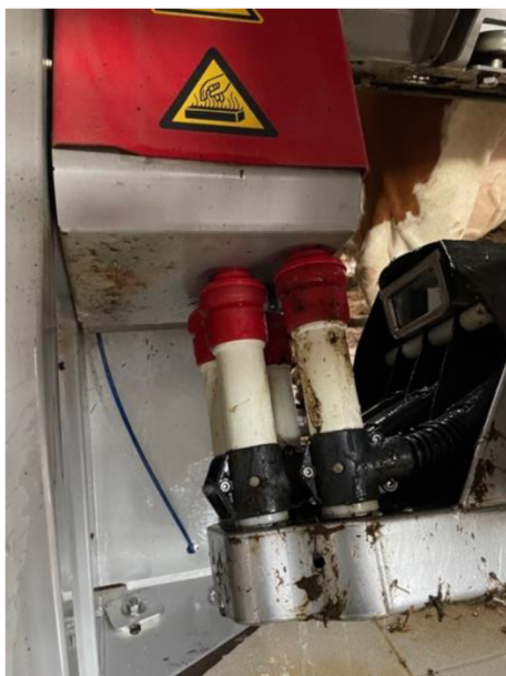
obr. P. 6 Pulsátory a laser na identifikaci struku
