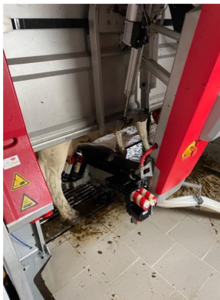
obr. P. 7 Rameno dojícího robota a kartáče na čištění a stimulaci struku
