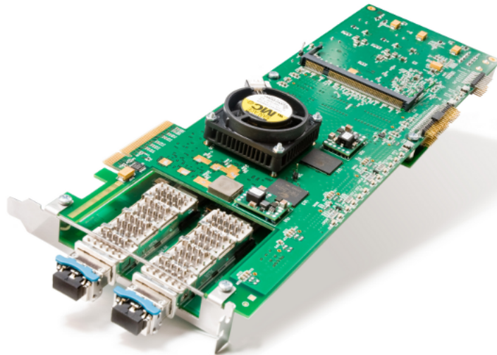
Obrázek 3.1: Karta COMBO-LX155T s připojenou COMBOI-10G2 kartou
