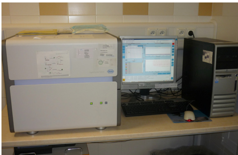
Obr. 13: LightCycler® 480 Real-Time PCR Systém propojený s PC sestavou (vlastní foto, 2011)
