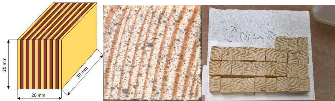
Obr. 20: Předepsané rozměry tlakových tělísek dle normy a skvrnitý povrch vytvořený pro snímání DIC
