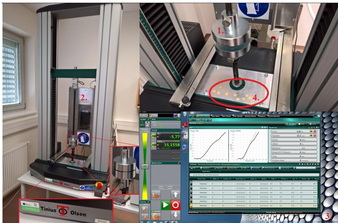
Obr. 25: Elektromechanický zkušební stroj Tinius Olsen, 1. zkušební čelisti, 2. klima komora (lze simulovat prostředí), 3. software Tinius Olsen Horizon, 4. velikost zkušebních vzorků vzhledem k čelistem
