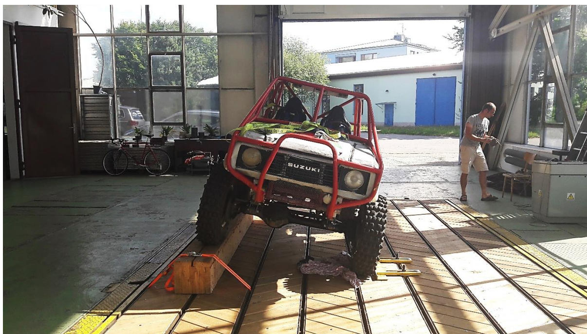
Obr. 39 - Prvek pro vyšší naklonění vozidla na plošině.
