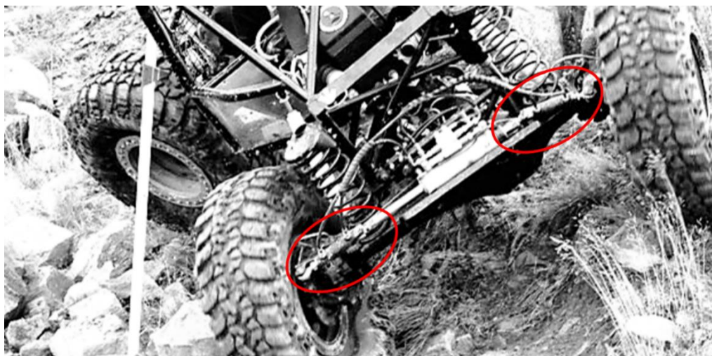
Obr. 5 - Přitáčení vnitřních kol pomocí přídavných přímočarých hydromotorů.
