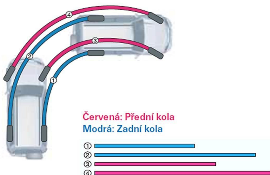
Obr. 2 - Dráhy jednotlivých kol vozidla při průjezdu zatáčkou.
