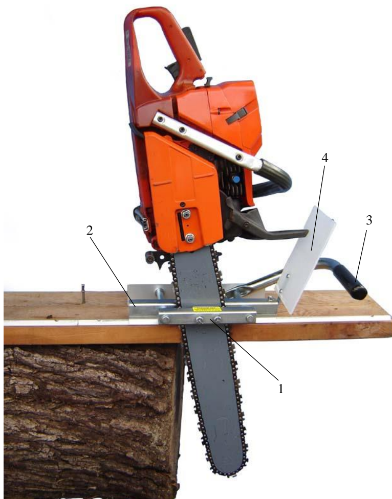
Obrázek 10 Omítací nástavec Edging mill fy GRANBERG
