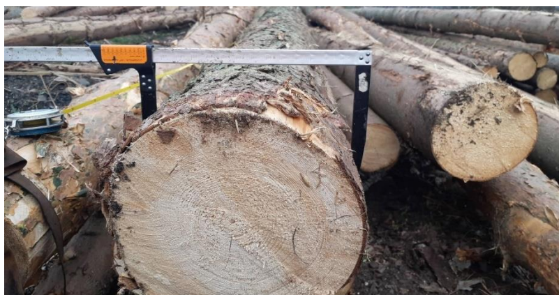
Měření středové a čepové tloušťky průměrkou ze dvou stran
