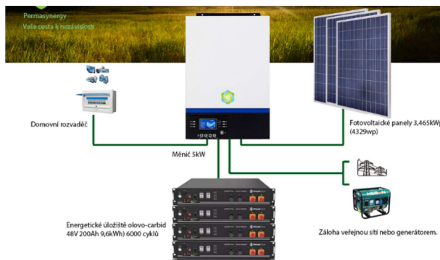
Obrázek 8 Schéma součástí FVE
