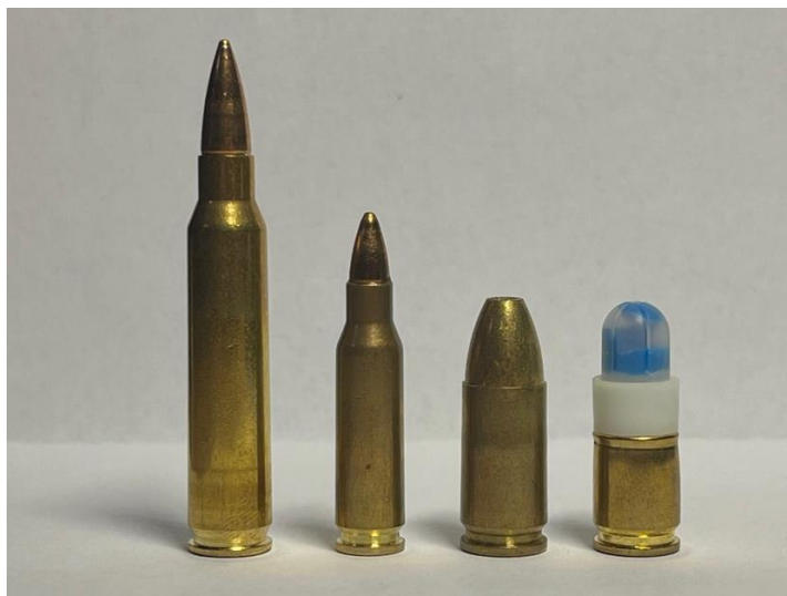
Obrázek č. 6: Náboje – zleva 5,56 x 45 mm NATO, 4,6 x 30 mm, 9 x 19 mm Luger HS, 9 mm Luger FX Simunition (zdroj: autor)
