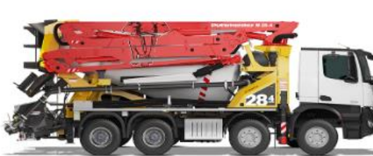
Obrázok 6.4-1: autodomiešavač s čerpadlom bet. Zmesi PUMI 28-4,77S, zdroj [31]
