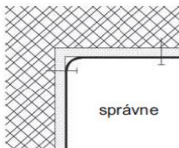
Obrázok 9.9-1: spôsob prilepenia dilatačnej pásky do rohu, zdroj [42]
