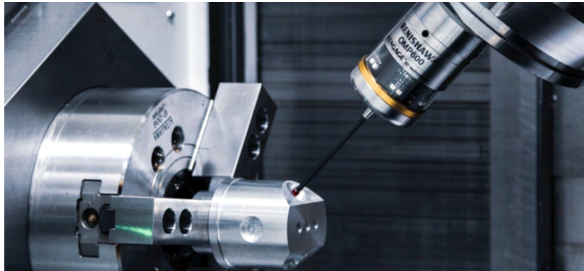
Obrázek č. 16: Sonda pro obráběcí stroje (Zdroj: Renishaw.cz, 2022)
