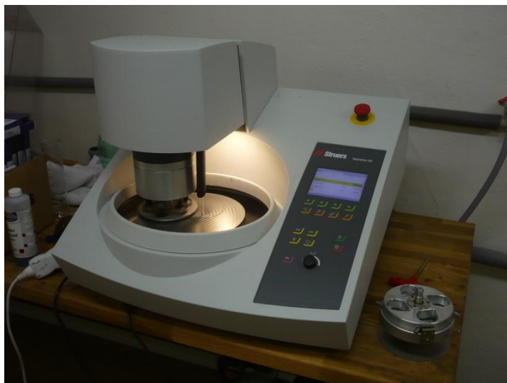
Obr. 26 Automatická leštička Struers Tegramin-25
