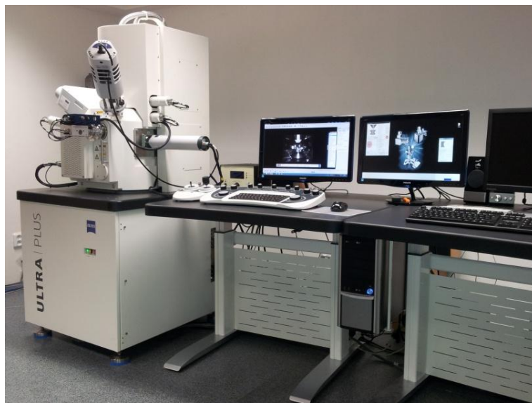
Obr. 37 Pracoviště skenovacího elektronového mikroskopu
