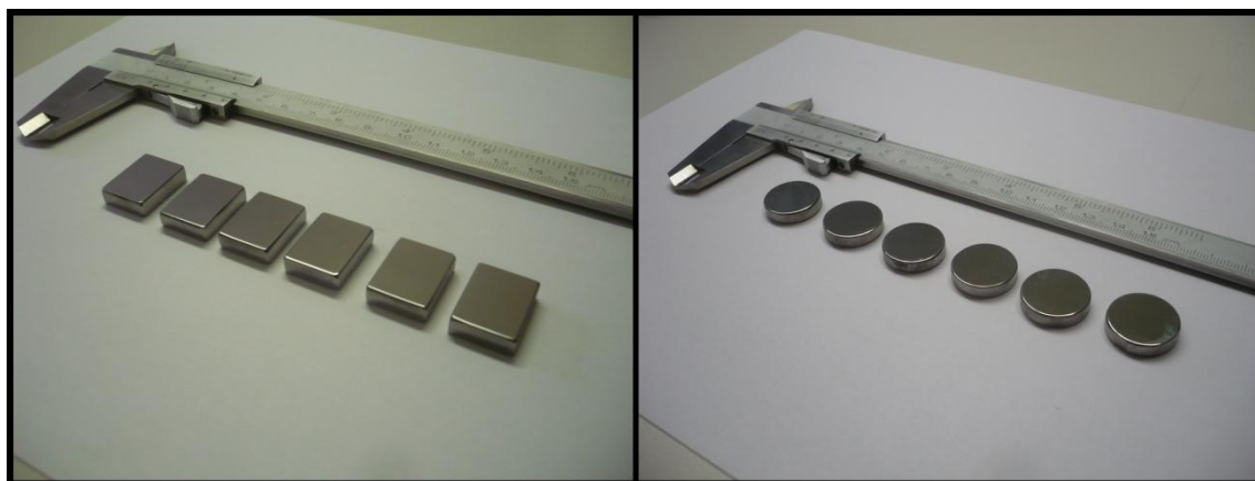
Obr. 24 Vyleštěné ocelové substráty: vlevo T91, vpravo A316Ti
