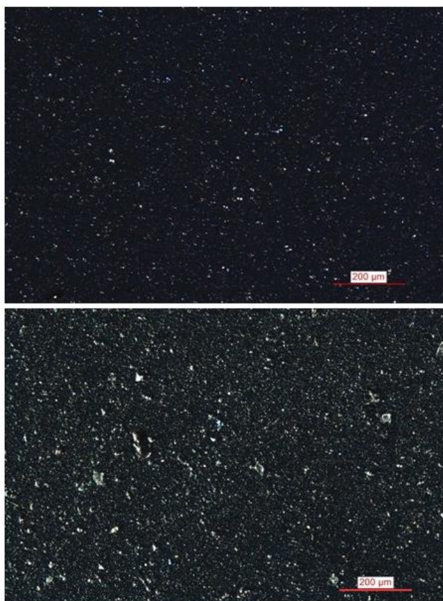
Obr. 17 Porovnání vzhledu povrchu směsné vrstvy (\text{Al}, \text{Cr})_2\text{O}_3 s různým podílem Cr [33]
