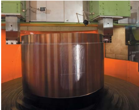
Obr. 1.3-1 Režim soustružení na karuselu
