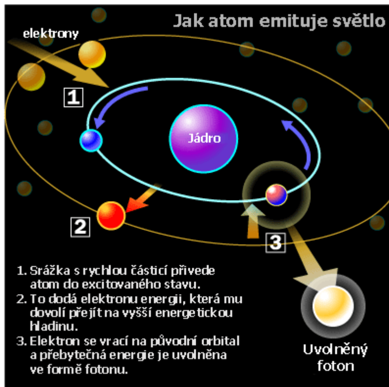
Obr. 16 – Schéma uvolnění fotonu z plynového iontu[2]
