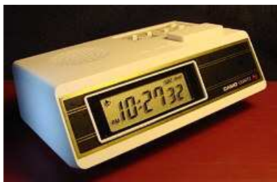
Obr. 10. Sedmi segmentový typ LCD displeje [1]
