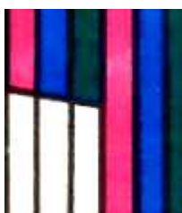
Obr. 7. Maska typu Trinitron CRT obrazovky [2]
