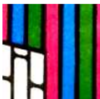
Obr. 8. Maska typu In line CRT obrazovky [2]
