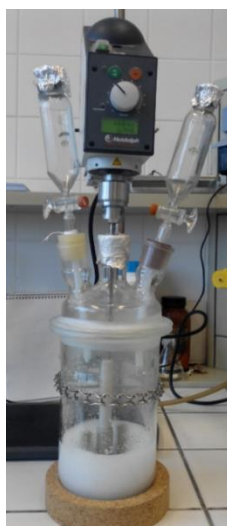
Obr. 12: Reaktor pro syntézu hydroxyapatitu
