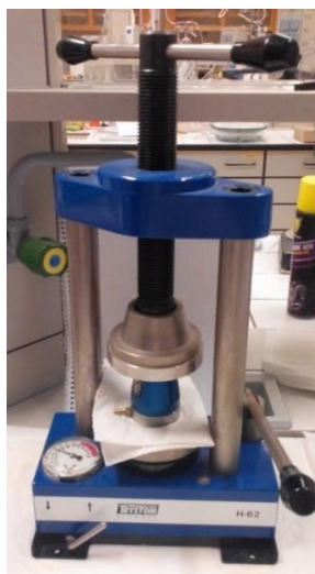
Obr. 11: Tabletovač pro výrobu lisovaných tablet
