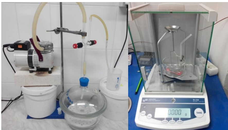
Obr. 15: Foto aparatury pro měření objemové hmotnosti a porozity a analytické váhy s aparaturou pro hustotní stanovení
