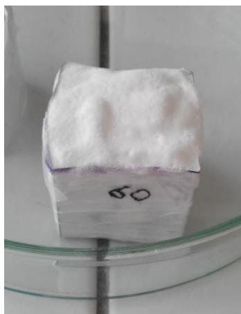
Obr. 14: Ukázka 60% napěněného korundu v hliníkové formě
