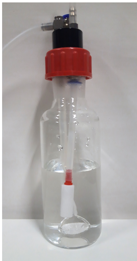
Obrázek 6.11: Probublávací zvlhčovač vzduchu ZV. Do zvlhčovače vedou dva vstupy a jeden výstup vzduchu. Ke vstupům jsou připojeny hadičky s porézními probublávači.
