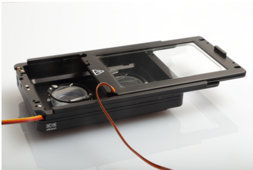
Obrázek 1.5: Stage Top inkubátor H301-K-FRAME s dvěma petriho miskami uchycenými do magnetické vložky. Převzato z [9].
