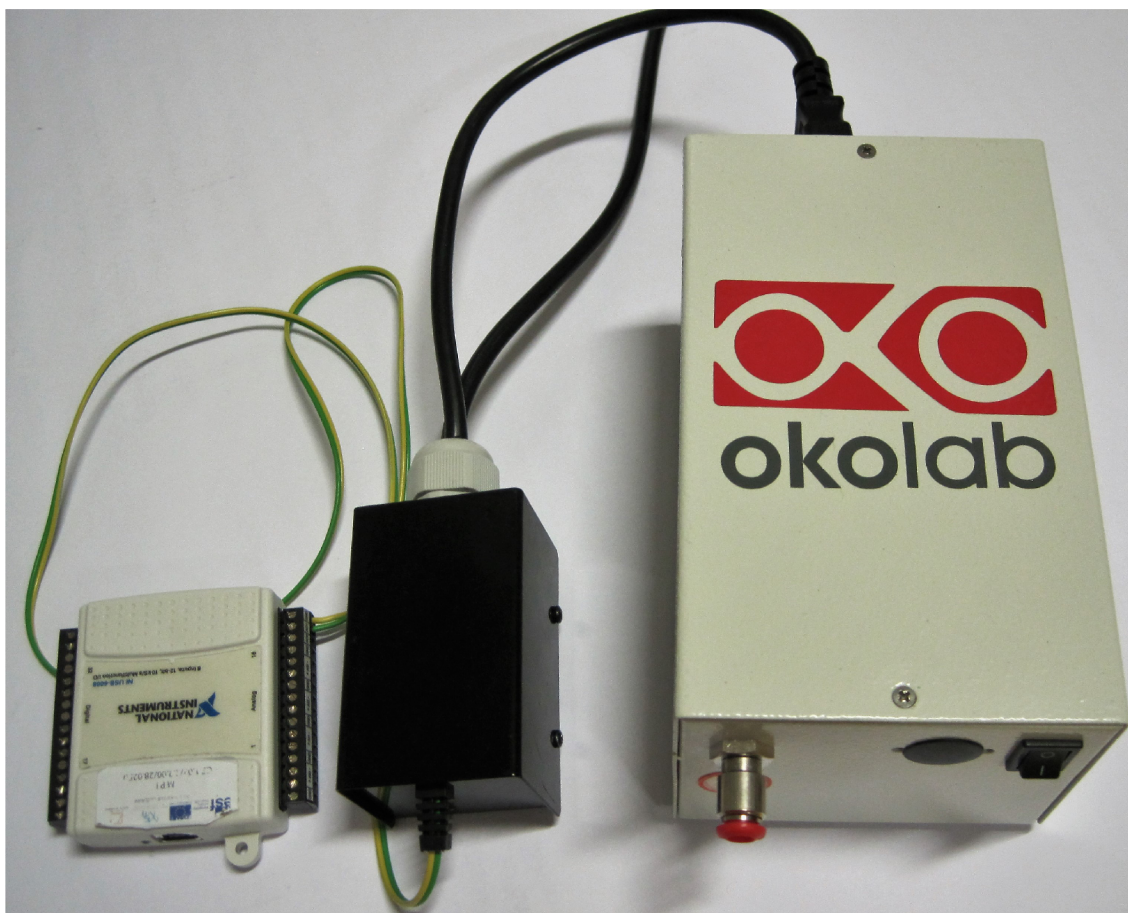
Obrázek 6.19: Zapojení karty National Instruments USB-6008, relé FOTEK SSR-40 DA v kovovém krytu a vzduchové pumpy OKO-AP Okolab.
