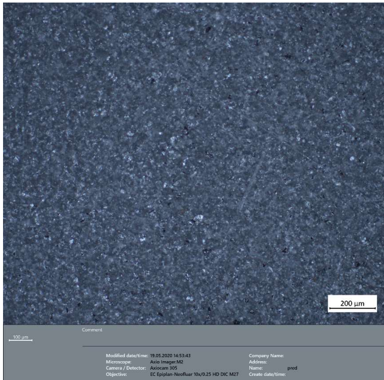
Obrázek 30: Test pórovitosti na vzorku před vypálením
