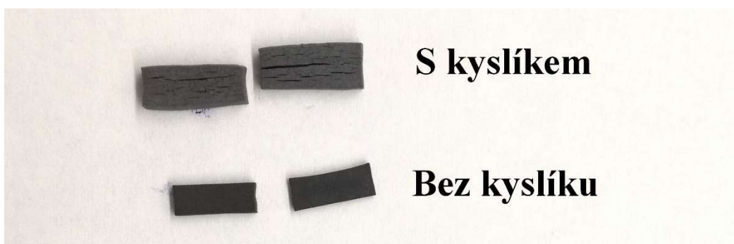
Obrázek 24: Porovnání vzorků vypálených s přítomností a bez přítomnosti kyslíku
