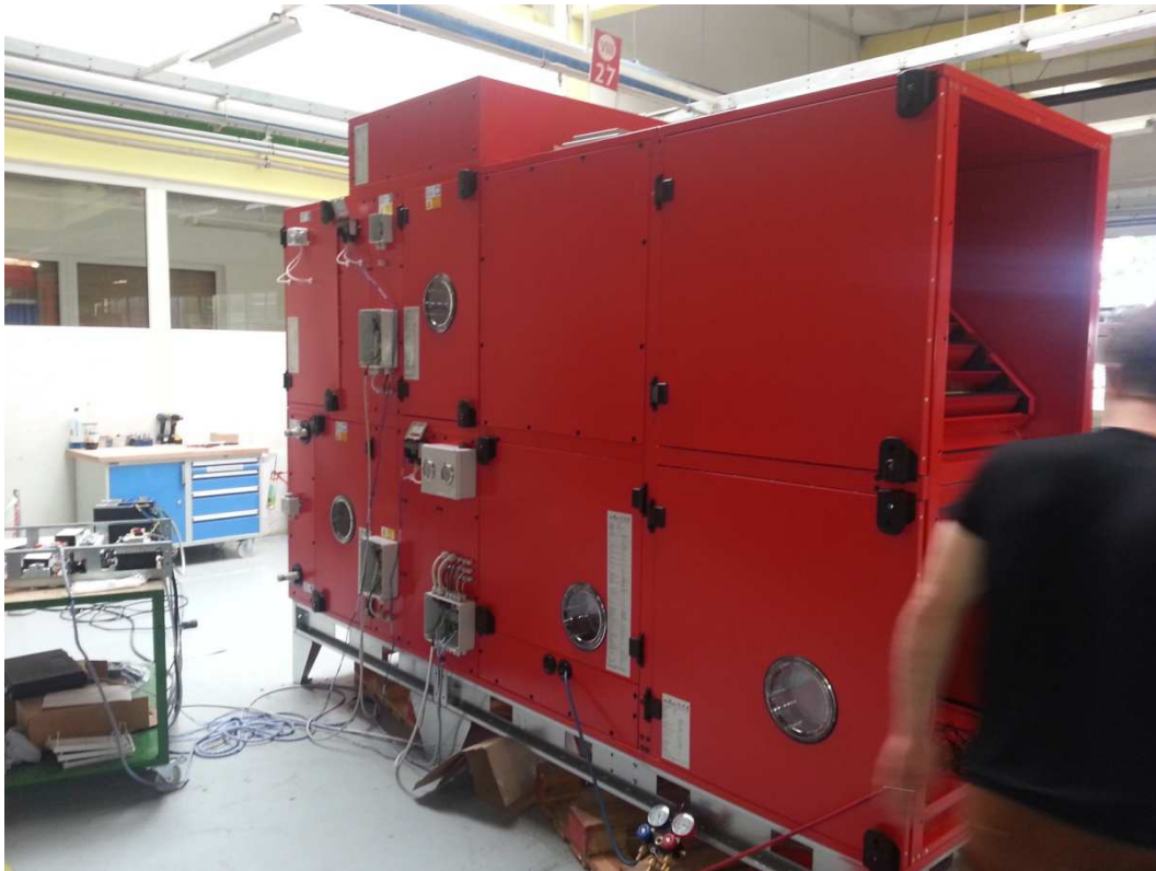
Obrázek: Část vzduchotechnické odvlhčovací jednotky firmy REMAK a.s. při testování ve výrobě
