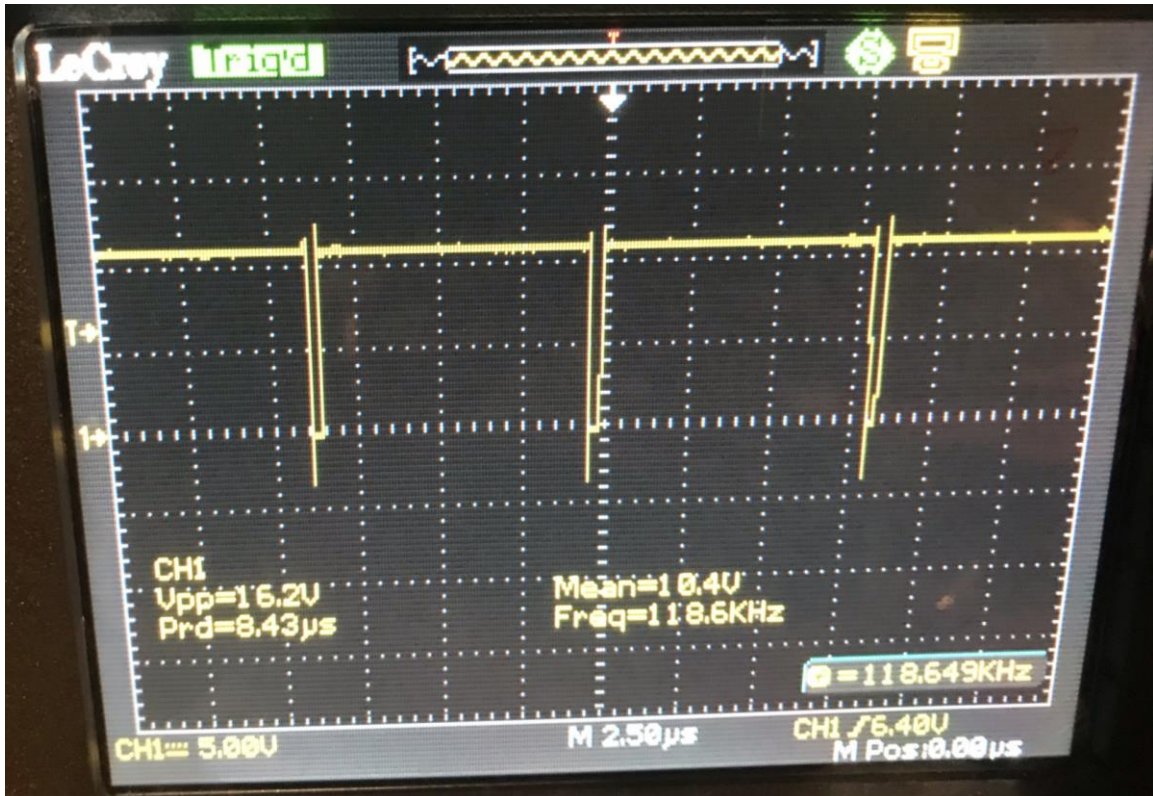
Příloha 4 – Průběh spínání tranzistoru 1 při kladném toku proudu nezátíženého měniče (režim BOOST)
