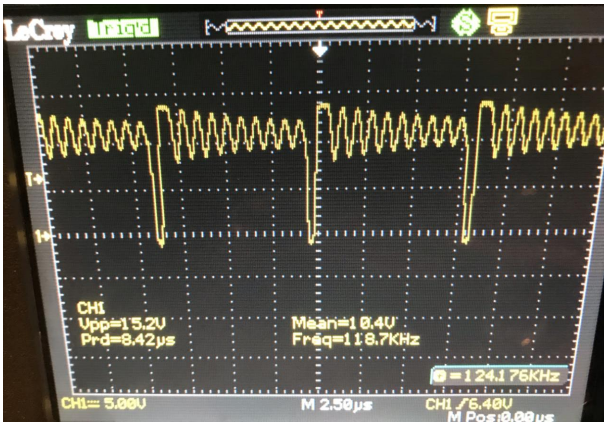
Příloha 3 – Průběh napětí na induktoru v kladném toku proudu nezátíženého měniče (režim BOOST)
