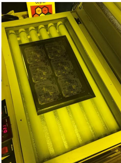
Obrázek 12 – proces vytvrzení fotorezistu
