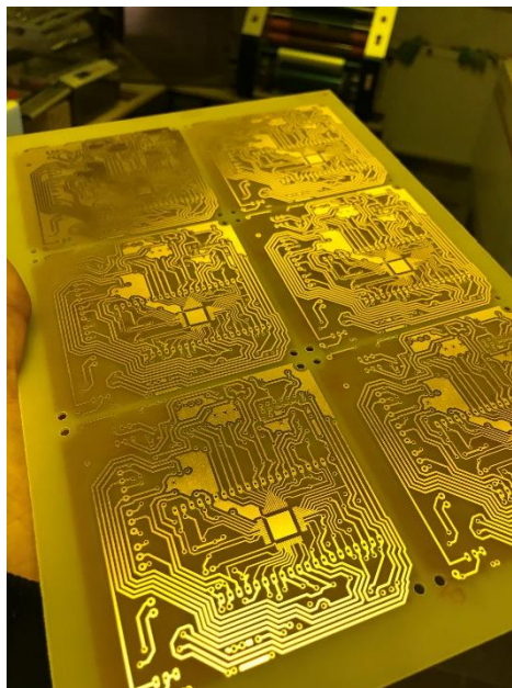
Obrázek 14 – deska plošeného spoje po leptacím procesu
