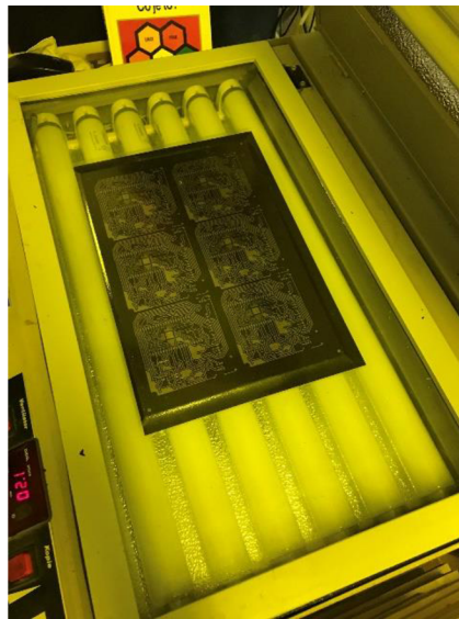
Obrázek 12 – proces vytvrzení fotorezistu
