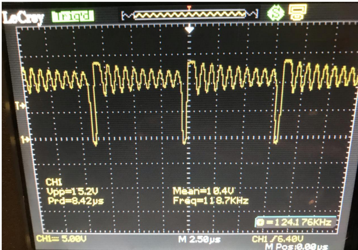
Příloha 3 – Průběh napětí na induktoru v kladném toku proudu nezatíženého měniče (režim BOOST)
