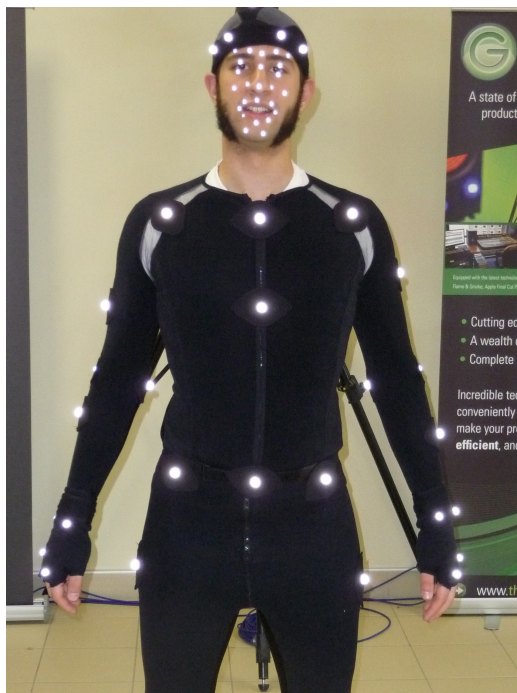
Obrázek 3.2: Značky využívané pro získávání pohybových dat. Fotografie z https://www.flickr.com/photos/thecleversheep/5700379379
