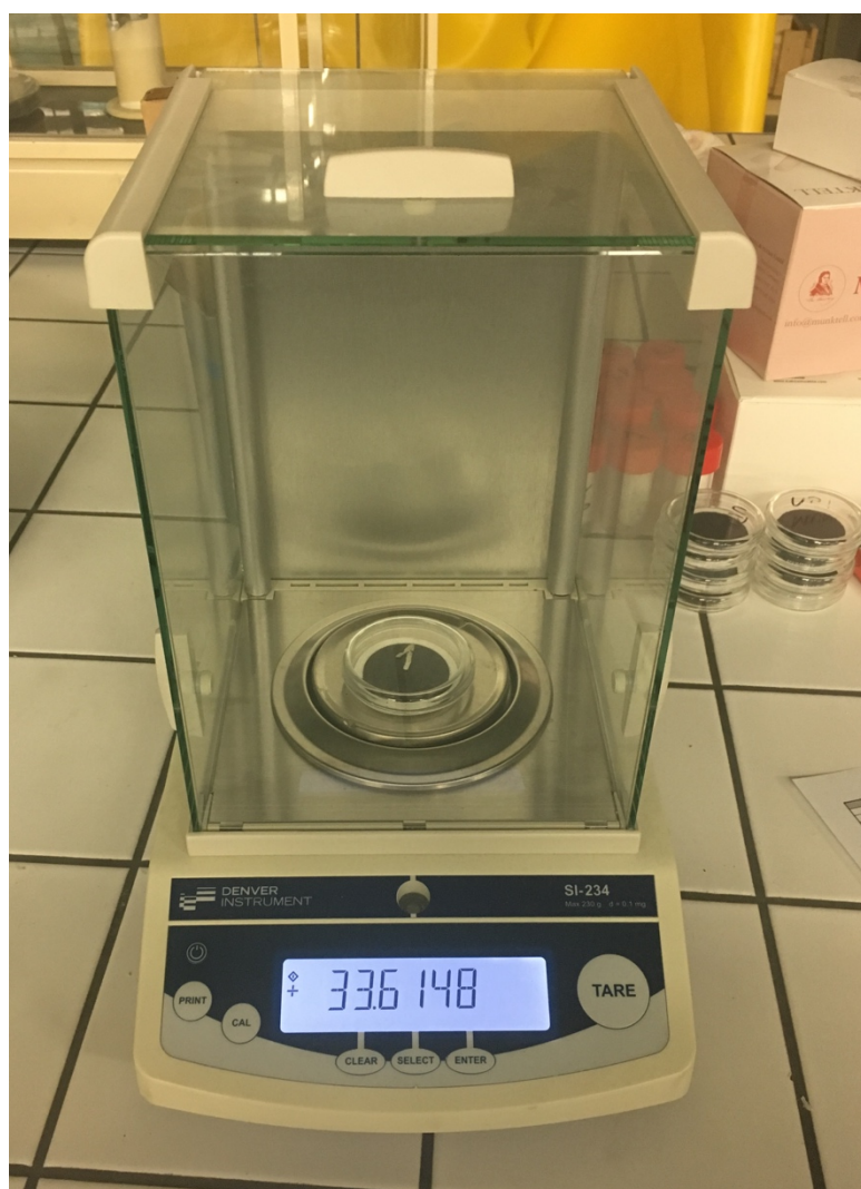
Obrázek 24: Vážení filtru s odebranými TZL
