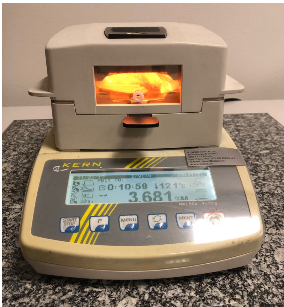
Obrázek 11: Kern při stanovování vlhkosti u štípaného dřeva
