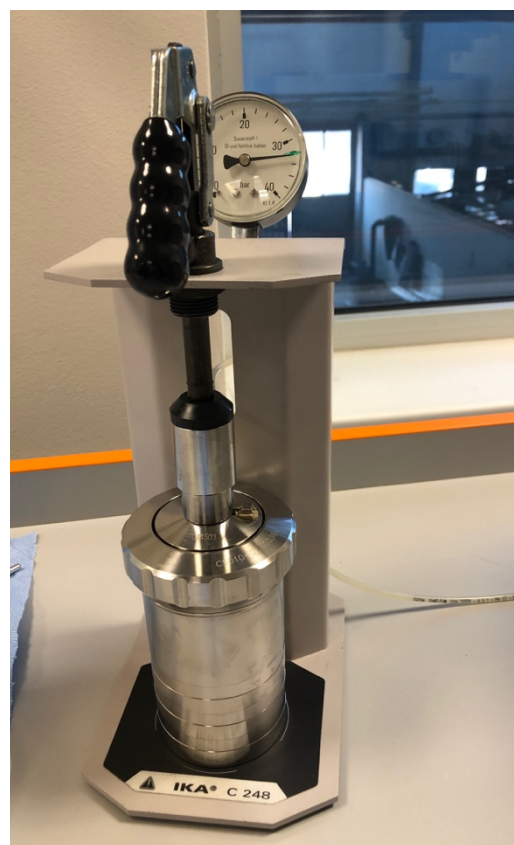
Obrázek 13: Kalorimetr IKA C 200 a kalorimetrická tlaková nádoba při tlakování
