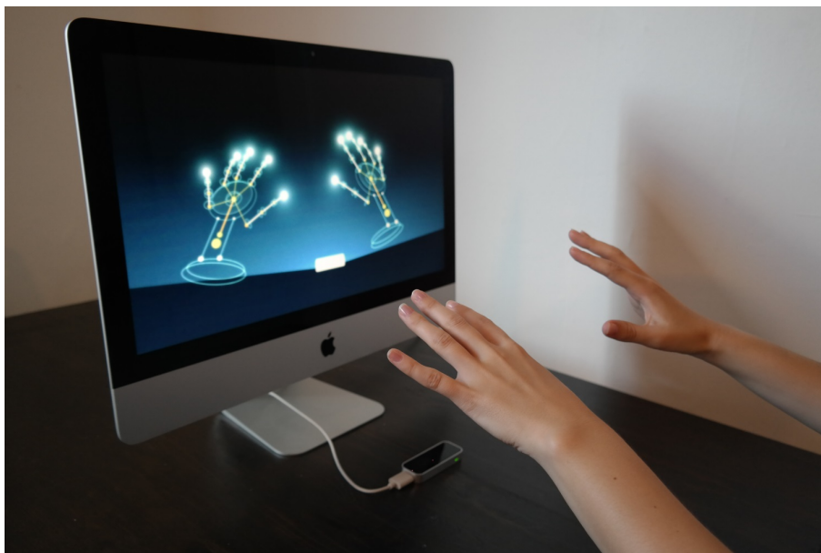
Obrázek 5.1: Model rukou při použití Leap motion a
