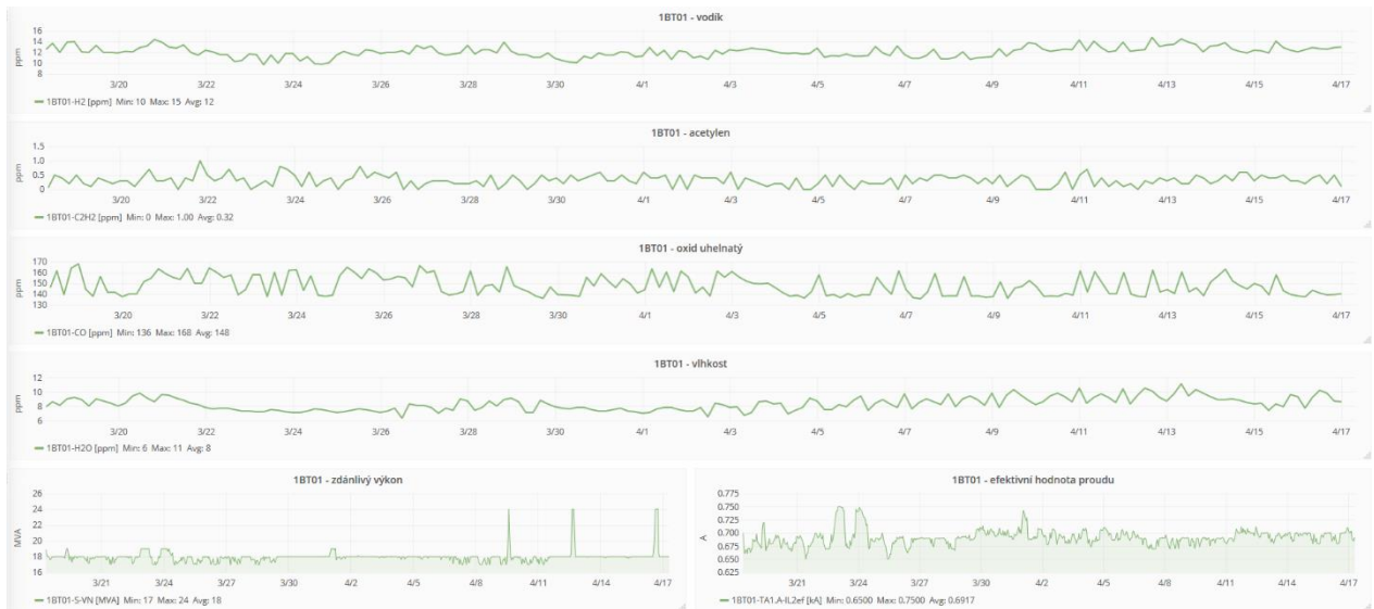
Obr. 9-42 Grafický záznam koncentrací plynů rozpuštěných v oleji
