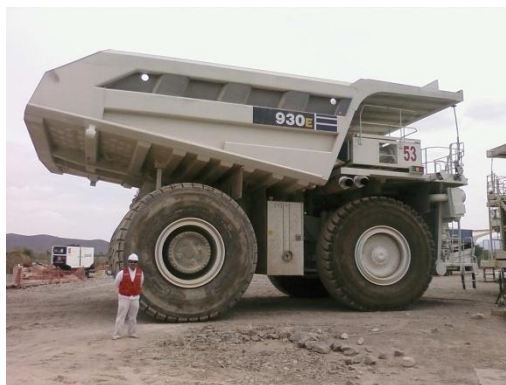
Obr. 13 Obří transportér Komatsu 930e poháněný dielelektrickým agregátem se systémem přímého elektrického pohonu kol [23]
