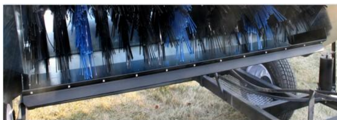
Obrázok 12: Rotujúca kefa vyčesávajúca semená
