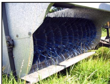
Obrázok 10: Rotujúca kefa vyčesávajúca semená
