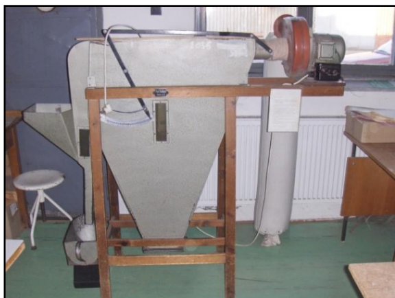
Obrázok 45: „Prefukovač“ semien, typ: DMK 07/2 MA, Nemecko, lokalita: Zubří (I. Semanová)
