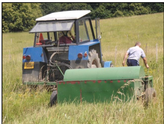
Obrázok 37: Vyčesávanie semien kefovým zberačom na zdrojovej ploche – Vojšické louky (I. Semanová)
