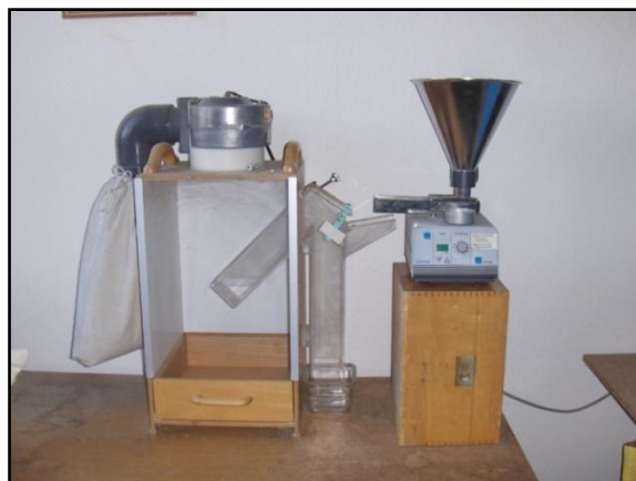
Obrázok 46: „Prefukovač“ semien Retsch DR 100, Nemecko (používaný pre malé semená), lokalita Zubří (I. Semanová)
