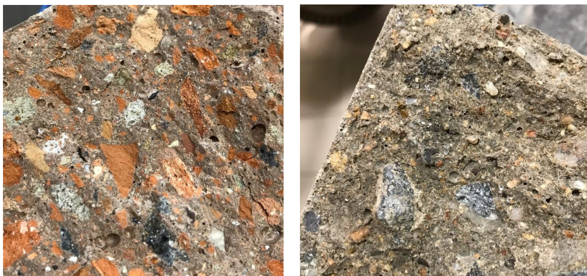
Obrázek 4: Detailní struktury betonu BPI (vpravo) a CC (vlevo)
