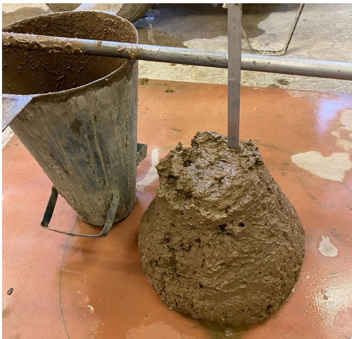
Otázek 2: Zkouška sednutí kužele u betonu CC
