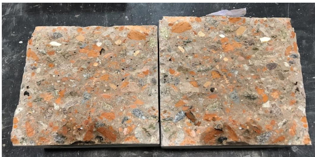
Obrázek 5: Hloubka průsaku tlakovou vodou u betonu CP
