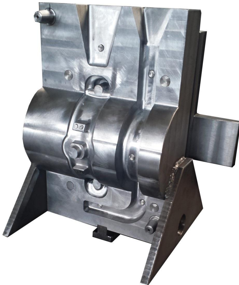
Obr. č. 16: Pohled na vyrobenou pohyblivou polovinu formy
