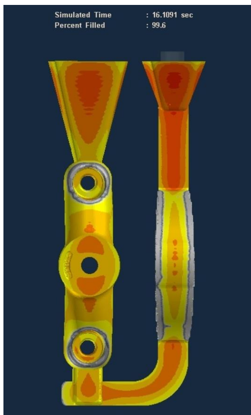
Obr. č. 12: Simulace znázornění míst teplotních uzlů
