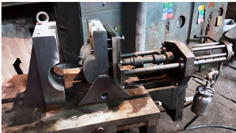
Obr. č. 18: Upevněná a otevřená forma na kokilovém licím stroji KS-2
