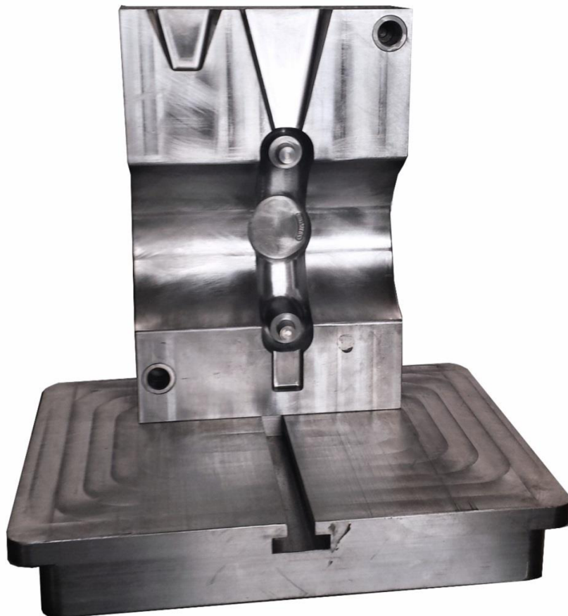
Obr. č. 15: Pohled na vyrobenou pevnou polovinu formy upevněnou na základní desce
