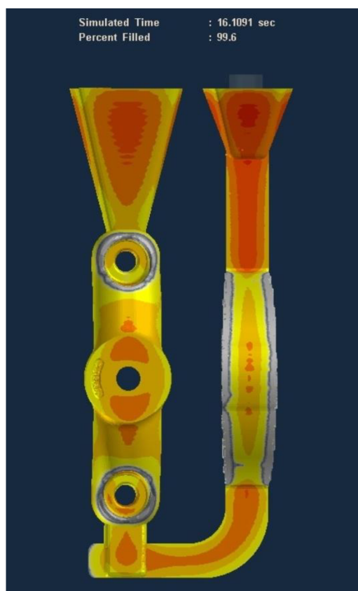
Obr. č. 12: Simulace znázornění míst teplotních uzlů
