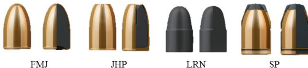
Obrázek 17: Srovnání jednotlivých typů pistolových střel používaných u ráže 9 x 19 mm Luger (ilustrace autora) [25]
