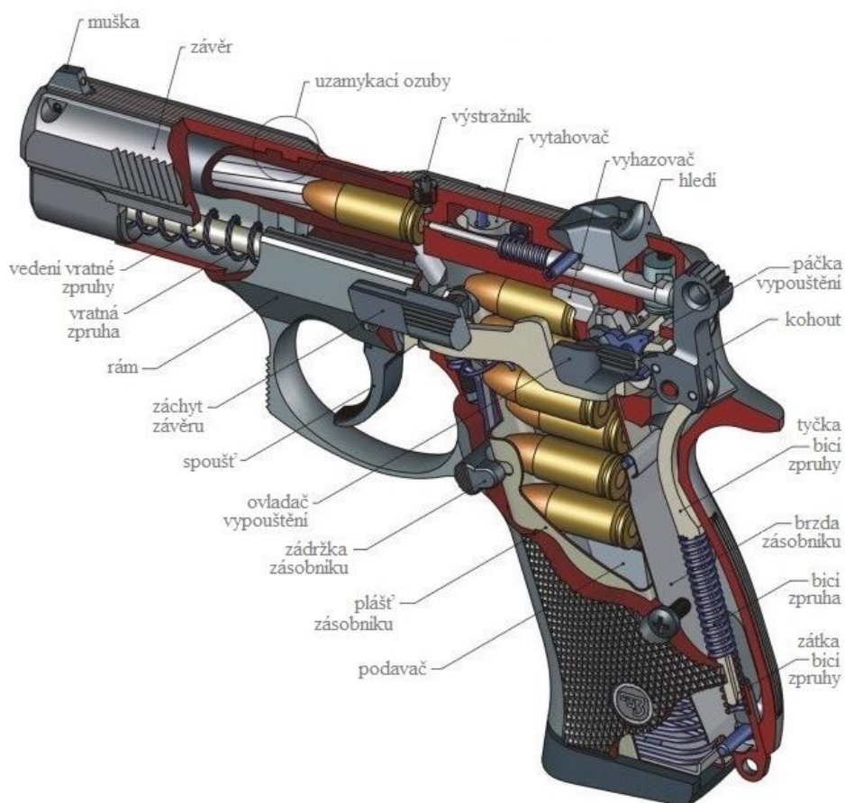
Obrázek 15: Části krátké ruční zbraně (pistole) CZ 75D Compact [28]
