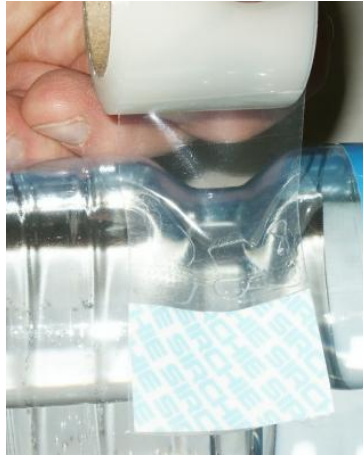
Obrázek 8: Polyethylenová daktyloskopická páska na nepravidelném povrchu [7]
