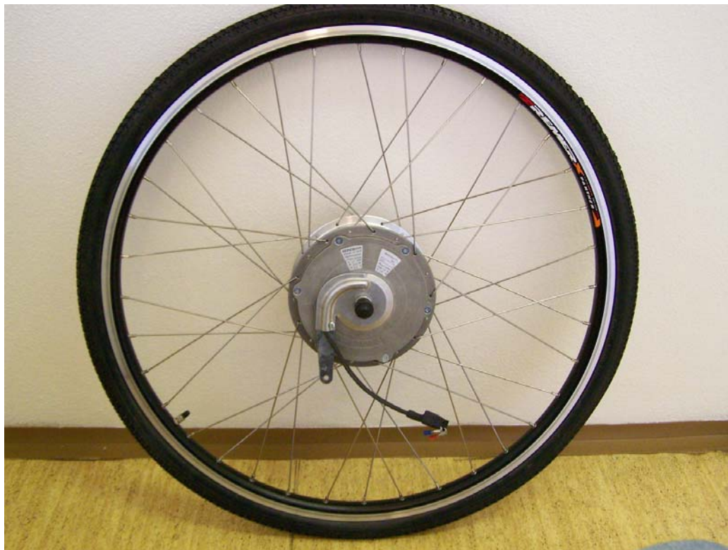
Obr.6.1.3 Stejnoseměrný motor Heinzmann – 54Nm
